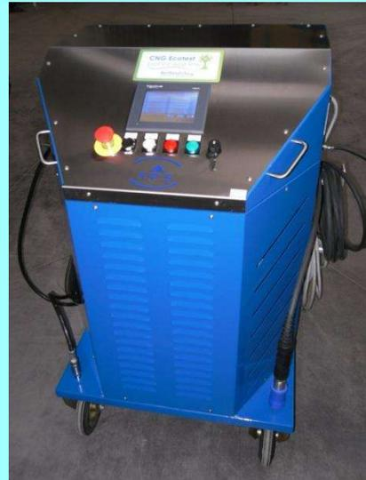
L'appareil ECOTEST L est un modèle destiné aux professionnels de la destruction automobile. Il permet le transfert et la récupération du gaz naturel, le contrôle de la pression résiduelle avant le démontage de la vanne. Il est possible de sélectionner la tension d'alimentation (12/24 V) des électrovannes. Il peut alimenter jusqu'à 12 électrovannes. Les flexibles d'alimentation et de refoulement sont identiques à Ecotest B. La station est équipée d'un tube d'évent.
