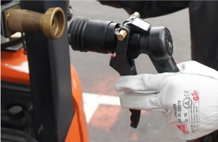
O. Décompresser le flexible d'emplissage à l'aide de la coupelle adaptatrice. Dans le même temps, alimenter la pompe en air quelques instants pour bien vider le circuit du gaz restant. Pour cette opération il est indispensable de se tenir à l'extérieur des locaux, le pistolet ne doit pas être orienté en direction d'une personne ou d'un obstacle et toujours vers le haut, bras tendu. Pour cette opération, le technicien doit conserver ses gants et lunettes de protection.
