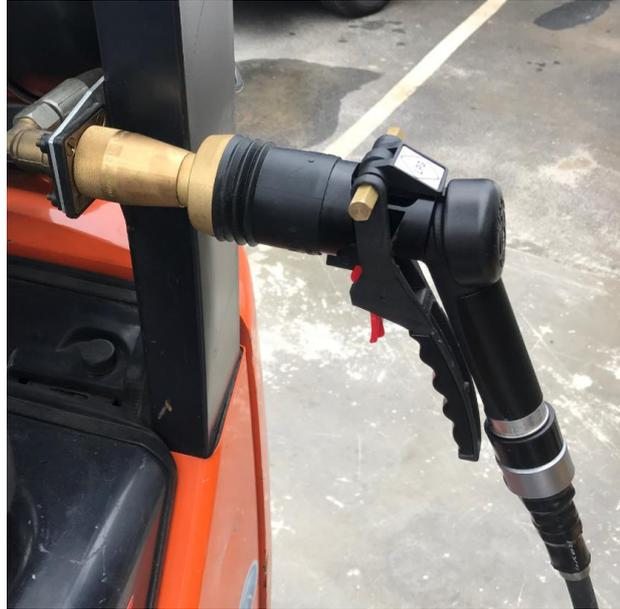
G. S'assurer que la vanne de régulation soit fermée et brancher le connecteur d'alimentation d'air comprimé, en ayant au préalable limité la pression de votre compresseur d'air comprimé à 3 bars.
